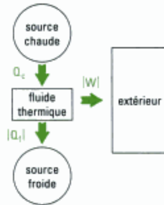
Figure 3 Les échanges d'énergie d'un moteur thermique ditherme.
