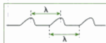
Fig. 5 – État de la surface de l'eau vue en coupe, à une date t donnée, dans le cas de la propagation d'une onde progressive périodique non sinusoïdale.
